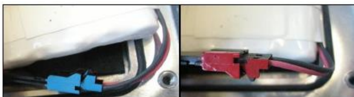
Rysunek 3-2 Złącza akumulatora: widok z boku (niebieskie, czerwone)
