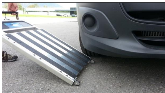
Rysunek 2-4: Możliwość manewrowania wagą
