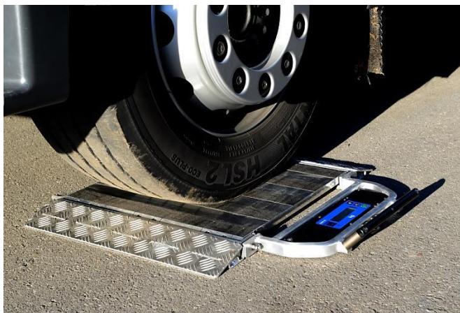
Rysunek 7-1: Położenie koła pojazdu (waga SAW 10C III z opcjonalnymi rampami)
